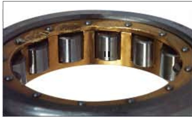
照片7-6 ●圆柱滚子轴承的保持架。 ●高强度黄铜车制保持架端面的变形。 ●安装时由过大的冲击载荷造成的。
