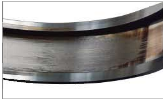
照片4-2 ● 照片4-1的外圈。 ● 滚道面圆周方向上的轻微擦伤。 ● 原因是润滑脂填充过多造成滚子打滑。
