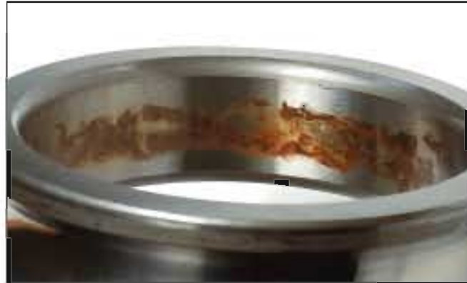
照片11-1 ● 深沟球轴承的内圈。 ● 内径面上的微动磨损。 ● 由于振动造成的损伤。
