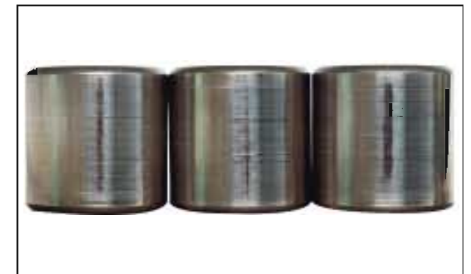
照片12-4 ● 圆柱滚子轴承的滚子。 ● 滚动面上的伪布氏压痕。 ● 停机时由外部振动造成的损伤。
