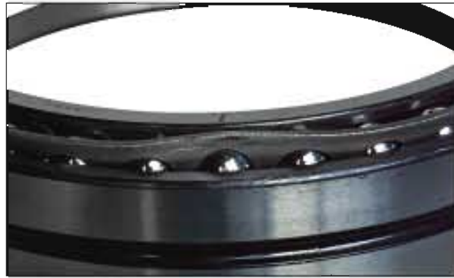
照片7-5 ●角接触球轴承的保持架。 ●钢板冲压保持架的变形。 ●原因是使用不当产生的冲击载荷。
