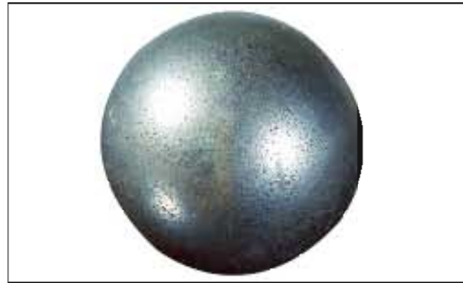
照片9-2 ● 照片9-1的钢球。 ● 滚动面呈现梨皮状
