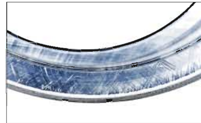
照片3-5 ● 推力调心滚子轴承的内圈。 ● 内圈挡边上的擦伤。 ● 异物侵入，轴向载荷过大造成的损伤。
