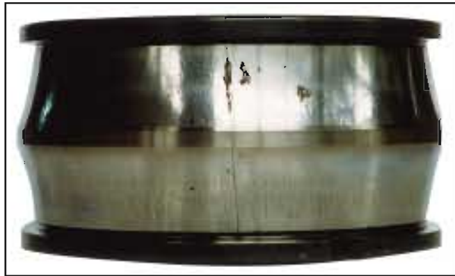
照片6-6 ● 调心滚子轴承的内圈。 ● 滚道面上的轴向裂纹。 ● 原因是轴与内圈的温差造成配合应力过大。
