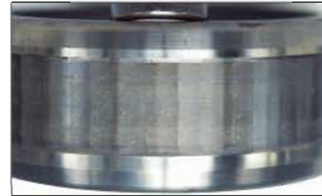
照片10-1 ● 圆柱滚子轴承的内圈。 ● 因波状磨损和由电蚀使滚道面上产生许多凹坑。 ● 由电蚀进一步发展而成。
