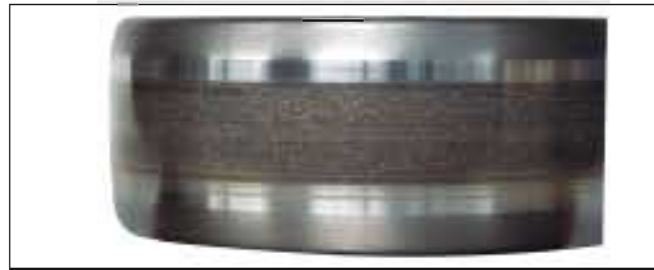
照片15-3 ● 圆柱滚子轴承的内圈。 ● 滚道面上的带状点蚀，表面伴有凹坑。
