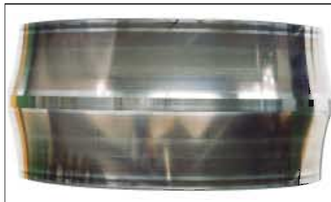
照片4-3 ● 调心滚子轴承的内圈。 ● 滚道面圆周方向上的轻微擦伤。 ● 因润滑不良造成的。
