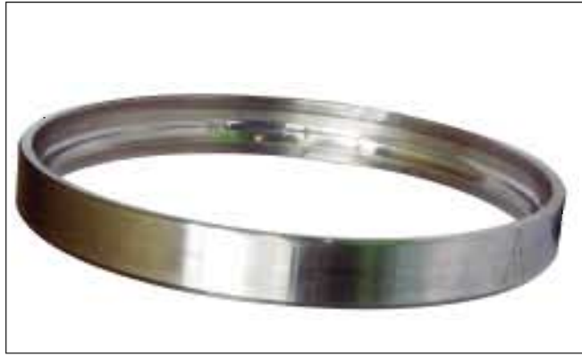
照片1-5 ●照片1-4的外圈。 ●沟道面上产生呈等球距分布的剥落。 ●停机时冲击载荷造成的压痕发展而成。
