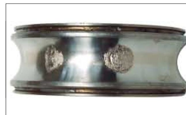
照片1-3 ● 深沟球轴承的内圈。 ● 沟道面上产生呈等球距分布的剥落。 ● 由安装时冲击载荷造成的压痕发展而成
