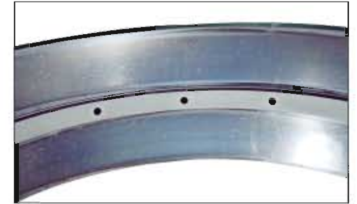
照片8-2 ●双列圆锥滚子轴承的外圈。 ●滚道面上产生了无数微小压痕。 ●由于异物侵入造成的。
