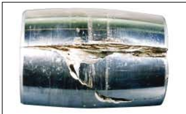
照片6-8 ● 调心滚子轴承的滚子。 ● 滚动面上的轴向裂缝。
