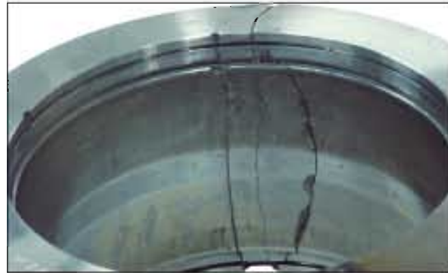
照片6-5 ● 照片6-4外圈的滚道面。 ● 外径面的裂缝扩展至滚道面。
