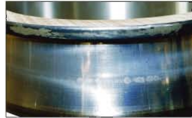
照片2-1 ●调心滚子轴承内圈。 ●滚道面中央的圆形花纹状剥皮。 ●润滑不良造成的损伤。
