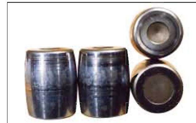
照片2-3 ●照片2-1的球面滚子。 ●滚动面中央的圆形花纹状剥皮。 ●润滑不良造成的损伤。
