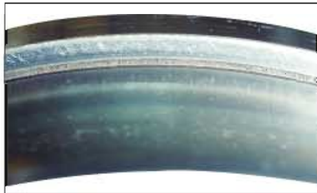
照片3-1 ● 调心滚子轴承的内圈。 ● 内圈大挡边上的擦伤。 ● 原因是急加、减速造成的滚子打滑。
