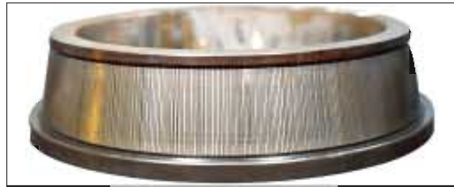
照片15-1 ● 圆锥滚子轴承的内圈。 ● 滚道面上的条纹状电蚀。
