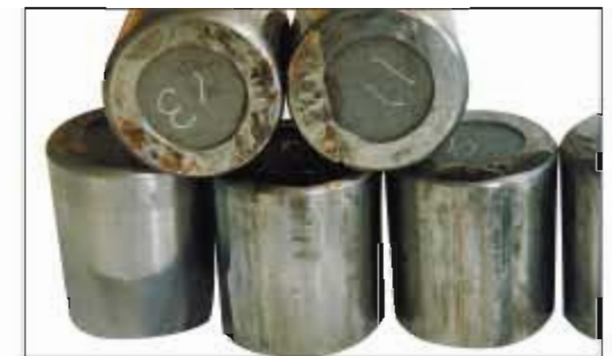
照片10-4 ● 照片10-3的圆锥滚子。 ● 滚子大端面上的阶梯状磨损。 ● 静止状态下承受过大载荷，由微动磨损发展而成的损伤。
