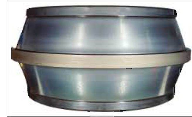
照片8-1 ●双列圆锥滚子轴承的内圈。 ●滚道面上产生了无数微小压痕。 ●由于异物侵入造成的。
