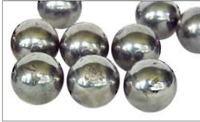
照片1-6 ●照片1-4的钢球。 ●钢球表面的剥落。 ●停机时冲击载荷造成的压痕发展而成。
