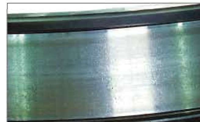
照片8-3 ●圆锥滚子轴承的内圈。 ●整个滚道面上产生了无数大小不等的压痕。 ●由于异物侵入造成的。
