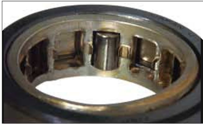
照片7-7 ●圆柱滚子轴承的保持架。 ●高强度黄铜车制保持架架梁的磨损与变形。
