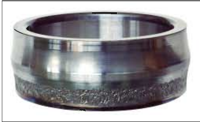
照片1-7 ●调心滚子轴承的内圈。 ●1列滚道面整周产生剥落。 ●过大轴向载荷造成的损伤。
