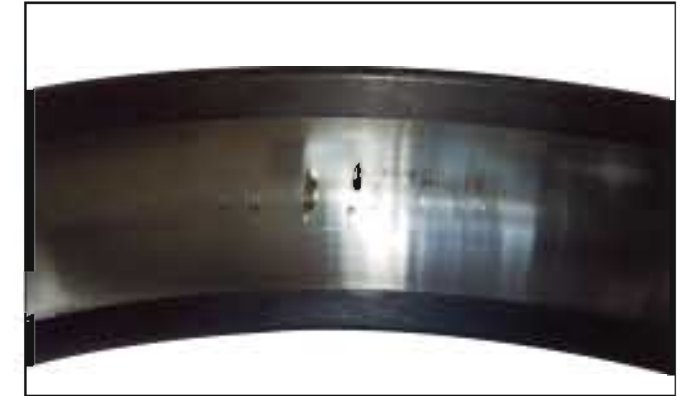
照片12-2 ● 照片12-1的外圈。 ● 滚道面上的伪布氏压痕。 ● 停机时由外部振动造成的损伤。
