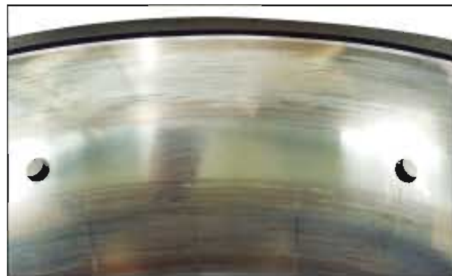
照片4-4 ● 照片4-3的外圈。 ● 滚道面圆周方向上的轻微擦伤。 ● 因润滑不良造成的。
