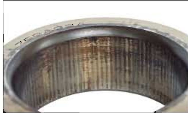
照片11-2 ● 角接触球轴承的内圈。 ● 整个内径面上显著的微动磨损。 ● 过盈量不足造成的损伤。
