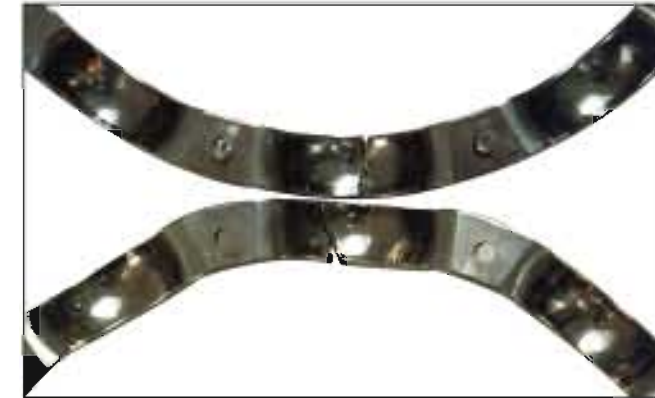
照片7-1 ● 深沟球轴承的保持架。 ● 钢板冲压保持架的兜孔折断。
