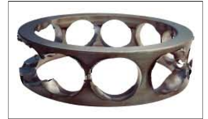
照片7-2 ● 角接触球轴承的保持架。 ● 铸铁车制保持架梁折断。 ● 原因是内外圈的安装倾斜。 ● 使保持架承受异常载荷。
