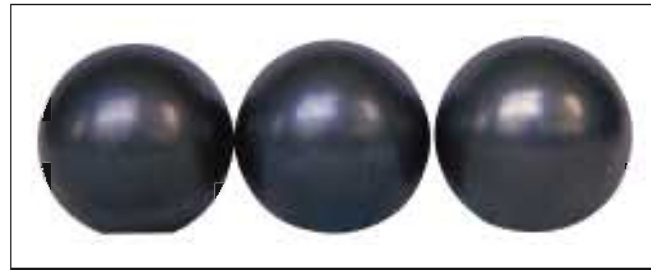
照片15-4 ● 深沟球轴承的钢球。 ● 深色的电蚀遍布整个滚动面。
