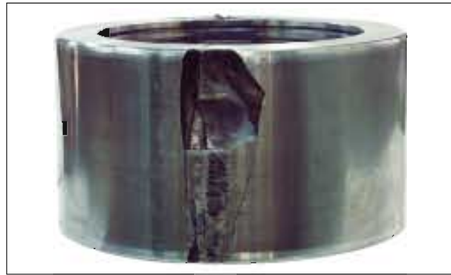
照片6-4 ● 外圈作为轧辊使用的双列圆柱滚子轴承的外圈（外圈旋转）。 ● 外径面上的裂缝。 ● 原因是外圈旋转不畅造成的平面磨损与发热。
