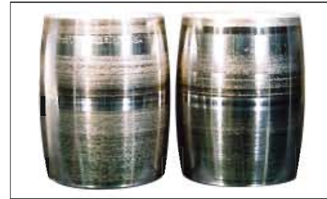
照片4-7 ● 照片4-5的球面滚子。 ● 滚动面中央的轻微擦伤。 ● 因润滑不良造成的。
