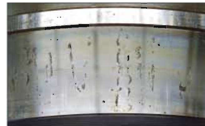
照片16-3 ● 调心滚子轴承的内圈。 ● 滚道面上的锈蚀呈滚子间距分布。 ● 水分侵入润滑剂中造成的。
