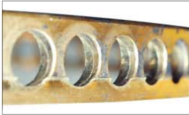
照片7-8 ●角接触球轴承的保持架。 ●高强度黄铜车制保持架兜孔及外径面上的阶梯状磨损。
