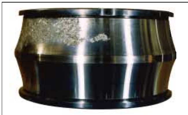
照片1-9 ●调心滚子轴承的内圈。 ●1列滚道面产生剥落。 ●润滑不良造成的损伤。
