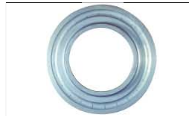
照片12-3 ● 推力球轴承的套圈。 ● 滚道面上等球距分布的伪布氏压痕。 ● 小角度反复摆动造成的损伤。
