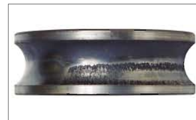
照片1-2 ● 角接触球轴承的内圈。 ● 沟道面上的剥落呈倾斜状态。 ● 安装时对中误差造成的。
