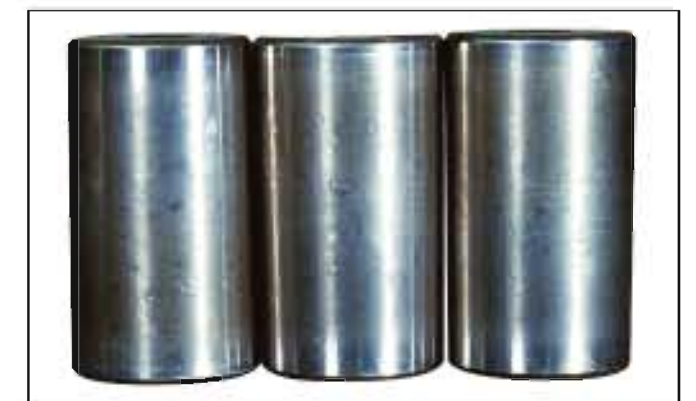
照片8-4 ●照片8-3的圆锥滚子。 ●整个滚动面上产生了无数大小不等的压痕。 ●由于异物侵入造成的。
