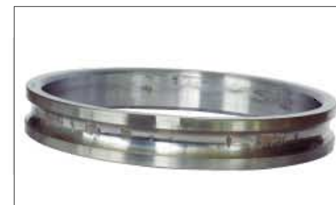
照片1-4 ● 角接触球轴承的内圈。 ● 沟道面上产生呈等球距分布的剥落。 ● 由停机时冲击载荷造成的压痕发展而成。
