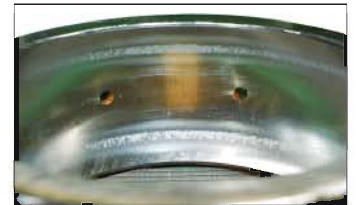
照片2-4 ●调心滚子轴承的内圈。 ●滚道面上上下整圈产生的剥皮。 ●润滑不良造成的损伤。
