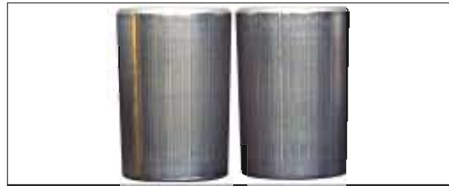
照片15-2 ● 照片15-1的圆锥滚子。 ● 滚动面上的条纹状电蚀。
