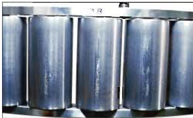
照片1-10 ●圆柱滚子轴承的滚子。 ●滚动面沿轴向产生的早期剥落。 ●安装不当造成的安装伤痕进一步发展而成。
