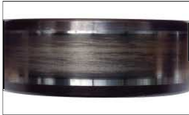
照片4-1 ● 圆柱滚子轴承的内圈。 ● 滚道面圆周方向上的轻微擦伤 ● 原因是润滑脂填充过多造成滚子打滑。
