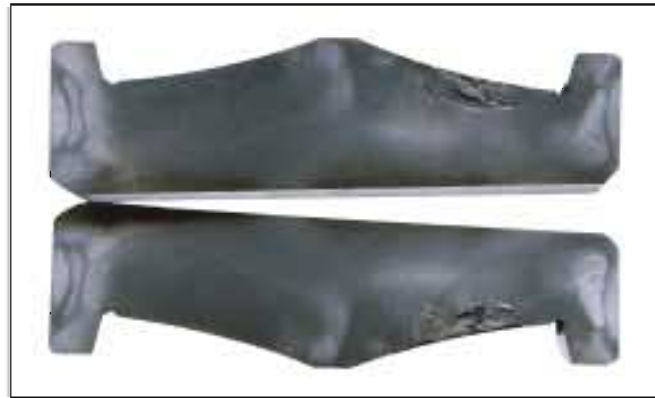
照片6-7 ● 照片6-6内圈裂纹处的截面。 ● 在滚道面正下方可看到起点
