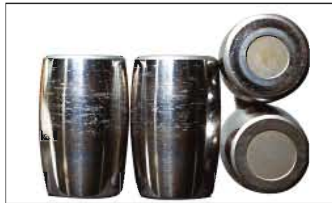
照片3-2 ● 照片3-1的球面滚子。 ● 滚子端面上的擦伤。 ● 原因是急加、减速造成的滚子打滑。
