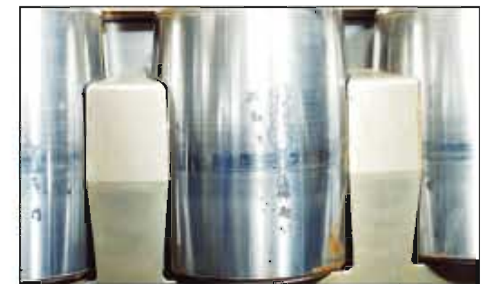
照片16-4 ● 调心滚子轴承的滚子。 ● 滚道面上产生的凹坑状锈蚀。 ● 保管过程中水分凝结造成的。
